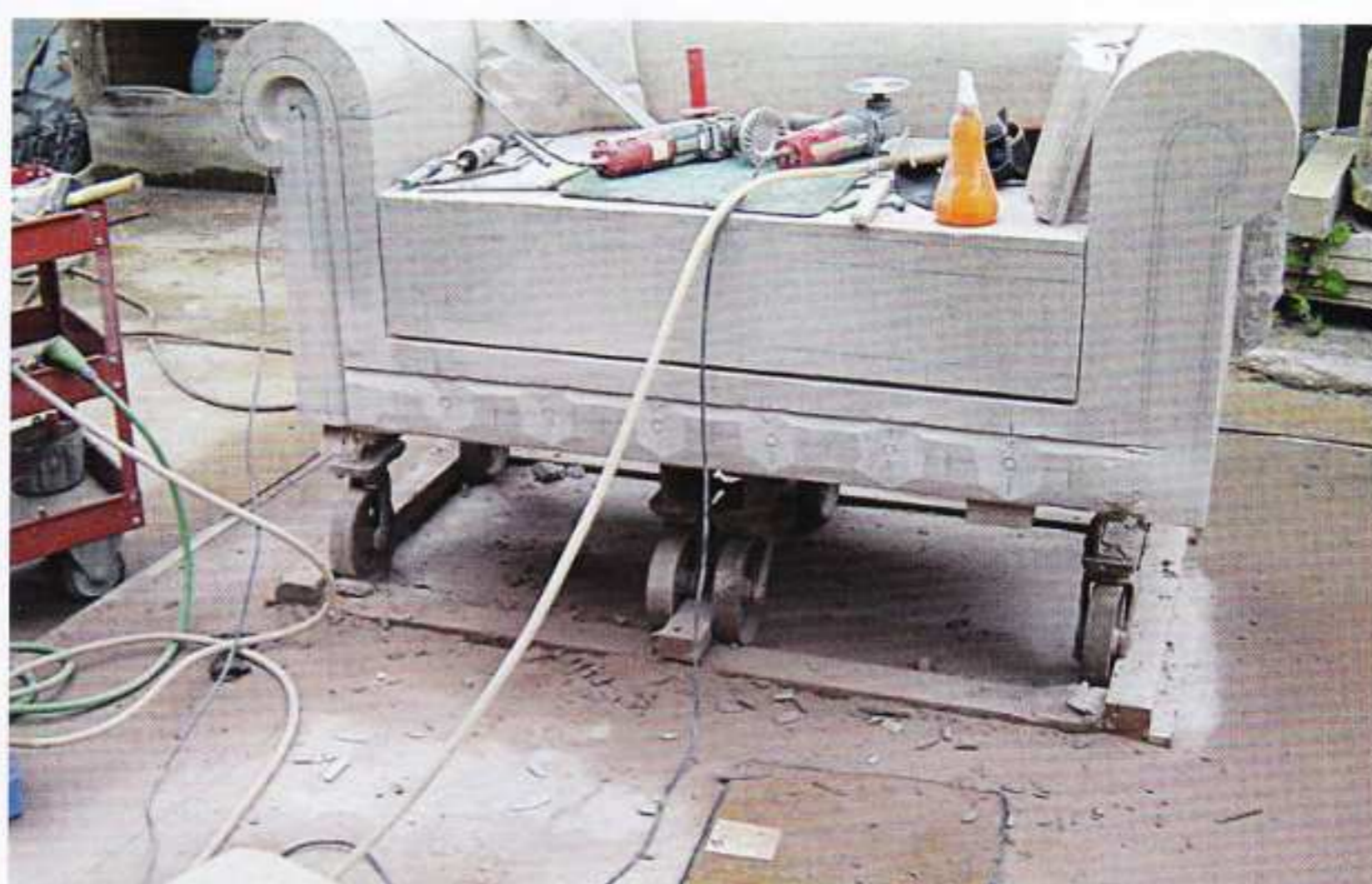
Mithilfe dieser selbst gebauten Konstruktion lassen sich die schweren Objekte rundherum bearbeiten. Fotos: Scheuermann/Reidel
